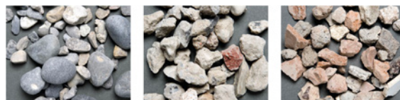
Fig. 2: Granulats pour béton (à gauche: granulat naturel arrondi, au milieu: granulat de béton, à droite: granulat de gravats mixtes)
