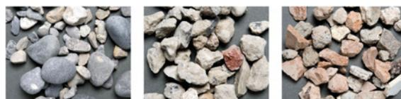
Figura 2: Aggregati per calcestruzzo (a sinistra: aggregati naturali arrotondati, al centro: granulato di calcestruzzo, a destra: granulato misto)
