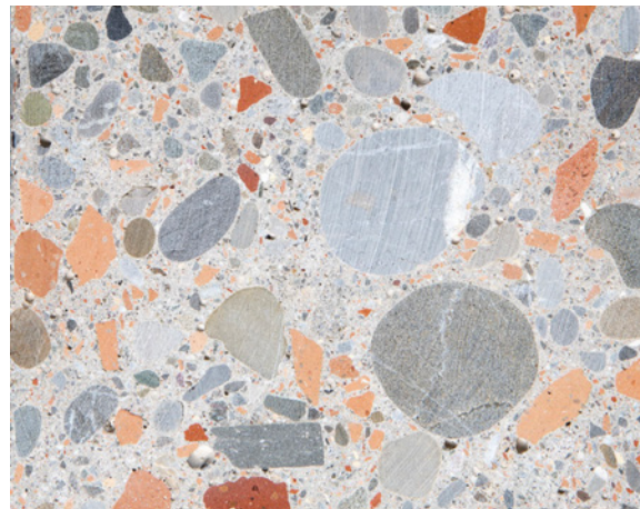
Beton mit rezyklierter Gesteinskörnung
